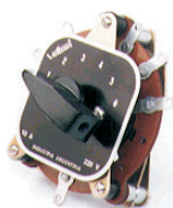
Llave selectora con contactos rozantes de 10A. Unipolar de 6, 8 ó 12posiciones.
